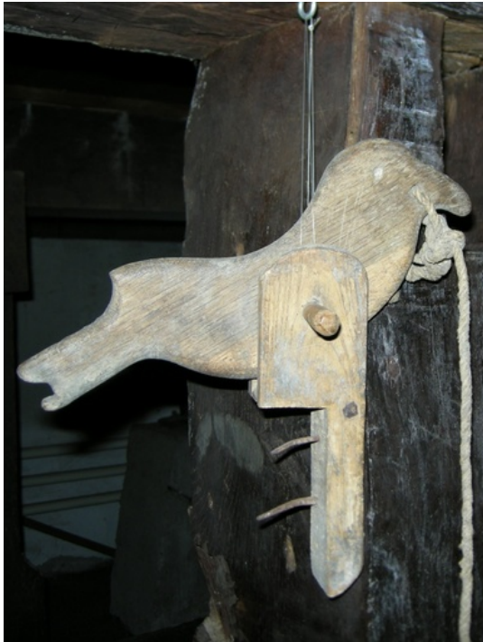
Abb. 50: Kippschub in Form einer Taube, Fragment vom Lautwerk
