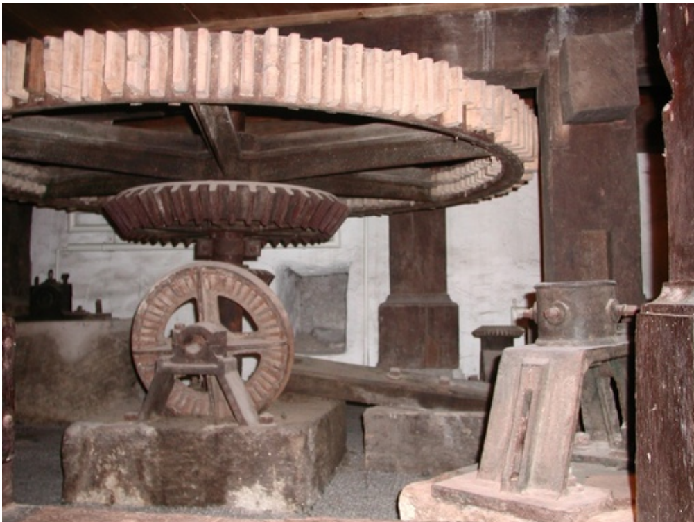
Abb. 47: Grosses Stirnrad über zwei Winkelgetrieben, Kegelzahnrad und Lager der Mühleisen.
